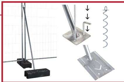
Stag 1071 festes til bakken ved hjelp av to feste-pinner (1011 el. 1669). Stag 1010 har større plate og kan festes enten med pinner, v-formet jordspyd eller med fotføtter på platen som motvekt.
